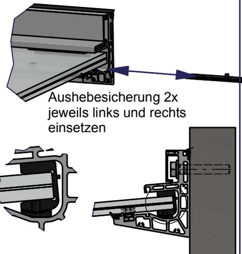
Aushebesicherung 2x jeweils links und rechts einsetzen
