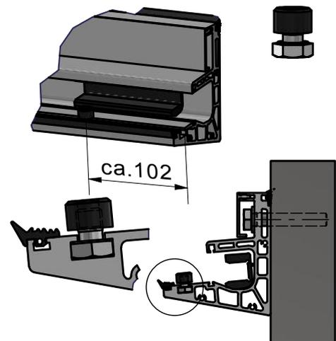
Das Glas in einem ca. 10° Winkel **von oben** in die Glasaufnahmen einführen. Zu beachten ist, dass die Glassicherungen und Glasbohrungen ineinander passen.
