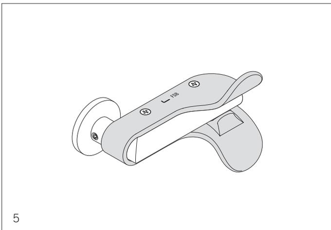
Der Klinkenaufsatz ist nicht für Fluchttüren nach EN 179:2008 zulässig und nach DIN 18273:1997-12 für Feuerschutztüren nicht empfehlenswert, da nach Punkt 5.2 der DIN 18273:1997-12 das Brandverhalten überprüft werden muss.
