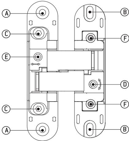
**A** Foro viti di fissaggio della cerniera allo stipite.
