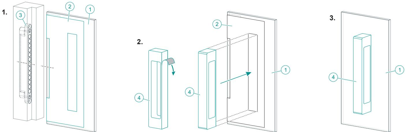
**DE** Die Klebefläche an der Glastür ① mit dem beiliegenden Reinigungstuch reinigen. Zur optimalen Kraftübertragung sollte der Griff ④ mittig zum Schließmagneten ③ ausgerichtet werden.
