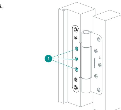
**DE** Den Türflügel mit dem Band in das Aufnahmeelement einsetzen, den Türflügel ausrichten und die 3 Klemmschrauben (1) fest anziehen (10–12 Nm).
