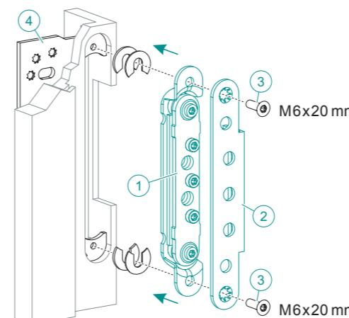
**FR** Insérer la plaque de fixation (4) par l'arrière dans le fraisage pour la stabiliser et fixer avec 6 vis à bois.
