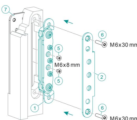
**FR** Insérer la plaque de fixation (7) par l'arrière dans le fraisage pour la stabiliser et fixer avec 6 vis à bois.
