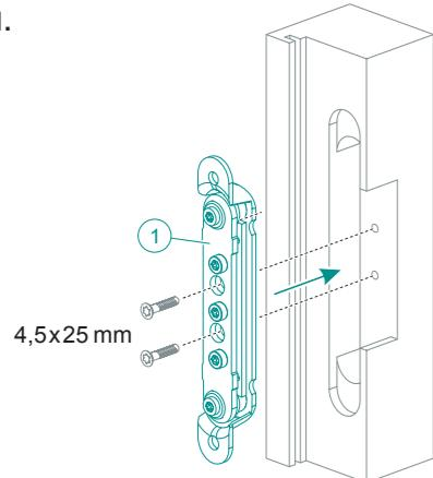
**DE** Das Aufnahmeelement (1) in die Zarge einsetzen, die Zarge vorbohren und das Aufnahmeelement mit 2 Holzschrauben befestigen.
