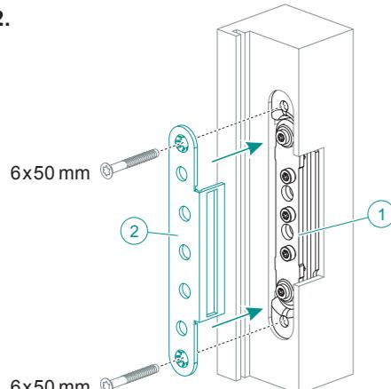
**DE** Die Abdeckung (2) auf das Aufnahmeelement (1) aufsetzen, die Zarge vorbohren und die Abdeckung (2) mit 2 Holzschrauben befestigen.
