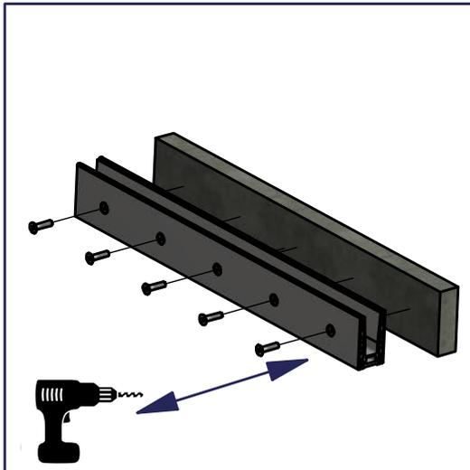
Optional können die Profile mit Hilfe von Verbindungsstiften **ISO 2338 (DIN7), Ø5x40mm** verbunden werden.
