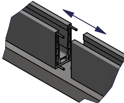
Im Außenbereich empfehlen wir Entwässerungsbohrungen Ø 10mm
