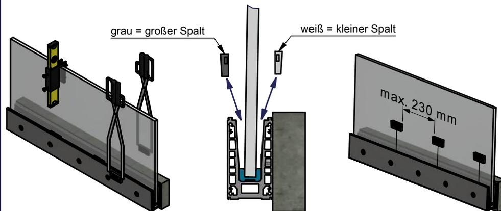
max. Verstellung 1° entspricht bei Glashöhe:
