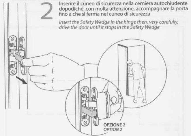
**2** Inserire il cuneo di sicurezza nella cerniera autochiudente dopodiché, con molta attenzione, accompagnare la porta fino a che si ferma nel cuneo di sicurezza
