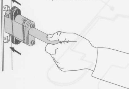
**3** Mantenere aperto la cerniera, inserire il Cuneo di Sicurezza, dopodichè con molta attenzione possiamo accompagnare la cerniera nella posizione naturale
