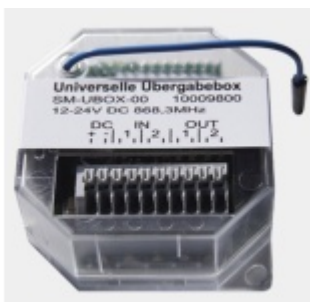
Ülock I/O modul - interface pro komunikaci se systémy jiných výrobců
